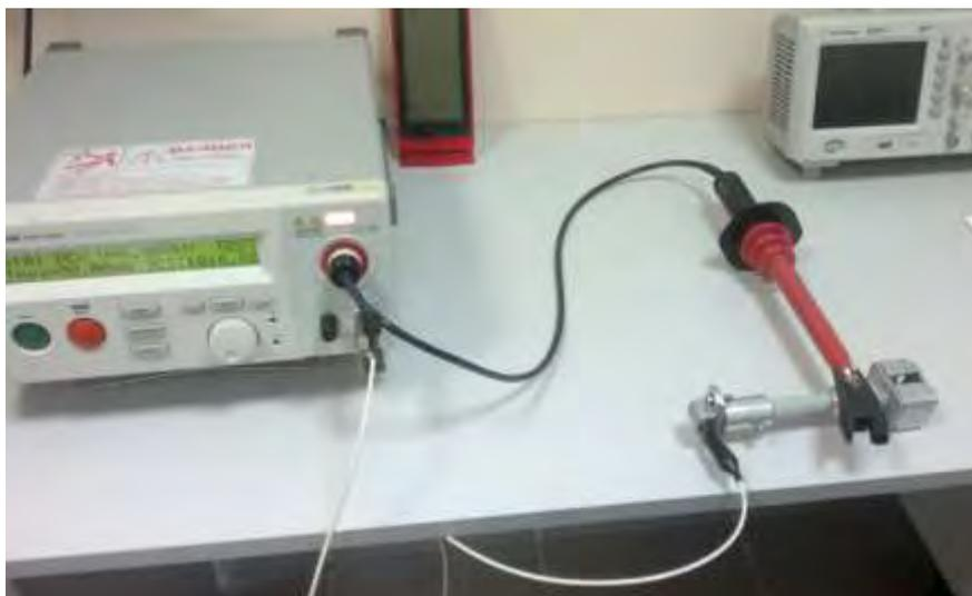
Рисунок 11 - Испытание УМК-КДИТ-ХР на электрическую прочность.
