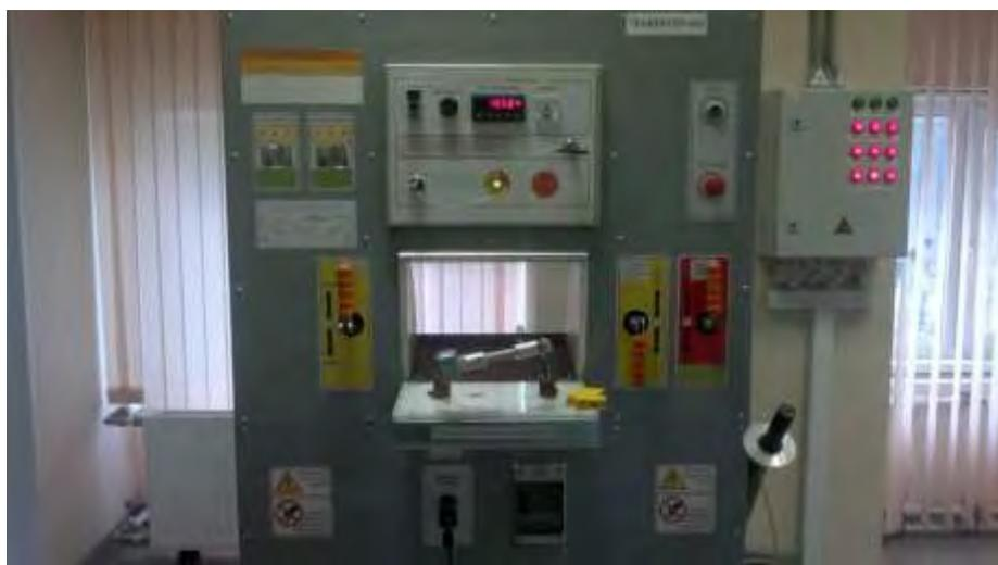
Рисунок 10 - Испытание УМК-КДИТ-ХР на импульсную стойкость.
