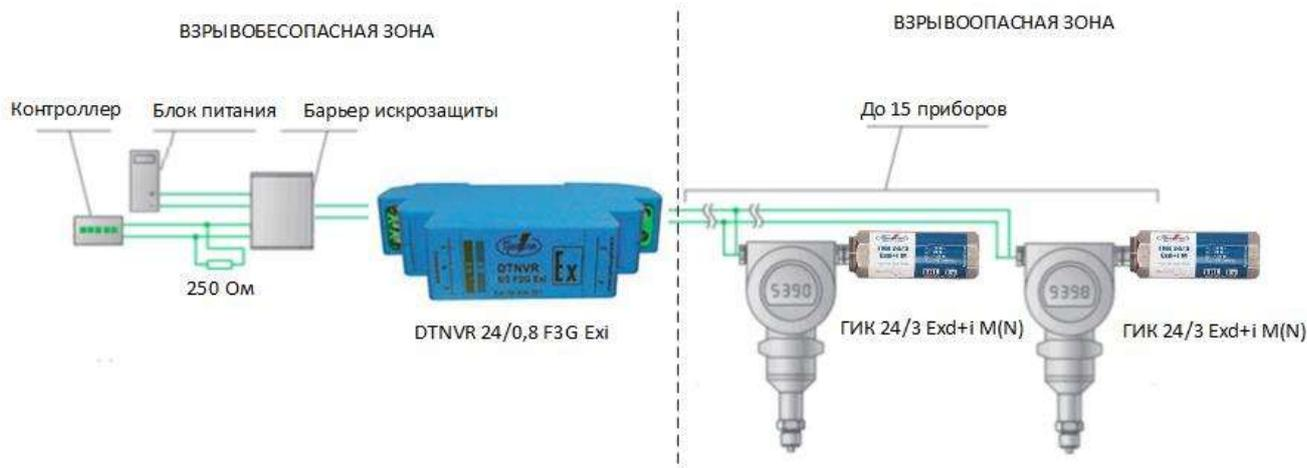
Рис. 6 – Сеть на основе протокола HART с использованием взрывозащиты вида искробезопасная электрическая цепь
